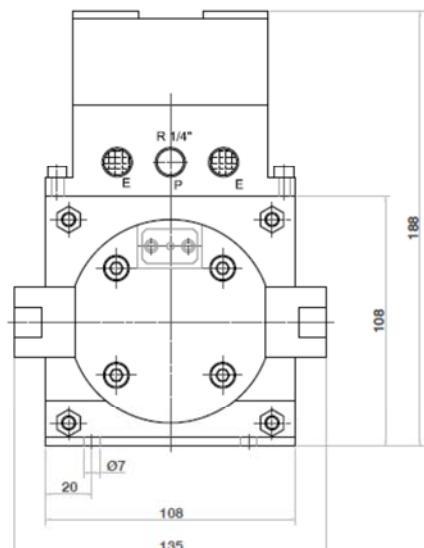
Hidrokraft hava tahrikli yüksek basınç sıvı pompası herhangi bir yönde monte edilebilir. Bununla birlikte, dikey pozisyon uzun ömrü sağlar, sızdırmazlık elemanlarının ömrünü uzatır ve hava tahrikine herhangi bir yüksek basınçlı sıvı sızıntısının önlenmesine yardımcı olur.
